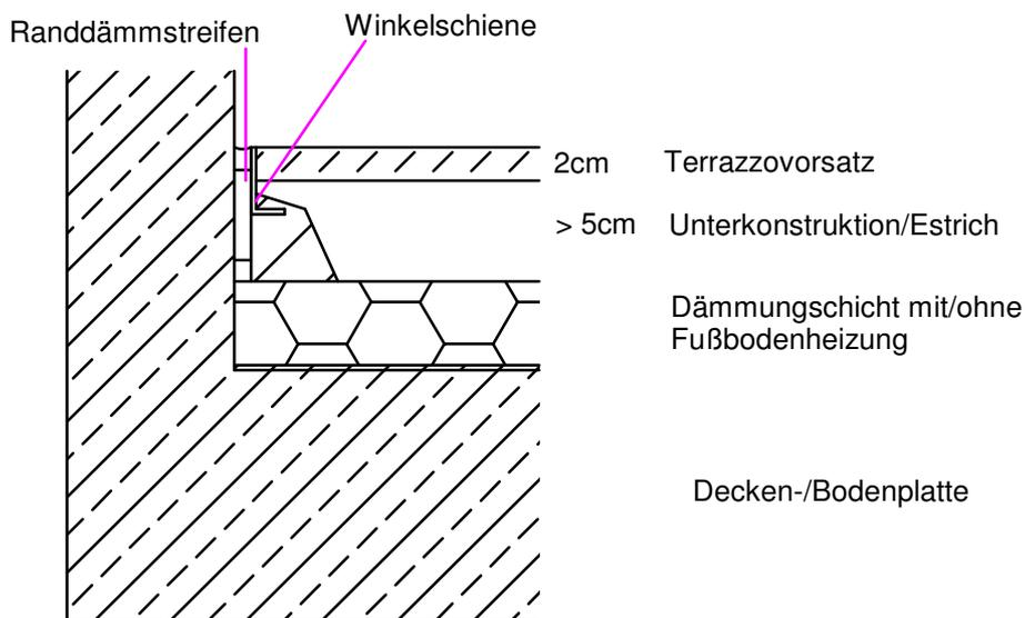
Das Einbringen des Terraplan erfolgt in zwei Schichten, die erste ist die Tragschicht (Estrichschicht) und die Zweite ist der Terrazzo-Vorsatz. Dies erfolgt im "Nass in Nass"-Verfahren.
